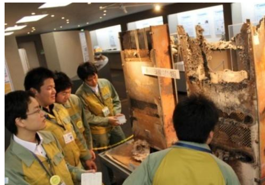
「失敗に学ぶ回廊」での研修風景（右図は1号機の余熱除去系配管破断部の実物）
