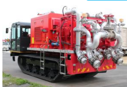
可搬型注水ポンプ車
