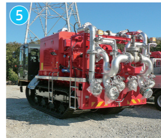
可搬型の注水ポンプ
