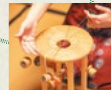
2種類の糸色×2束、金糸4束、計8束の糸を組みに配置。それを柄に合わせて規則的に移動しながら糸を組む。
