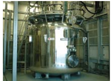
SMES (10,000kW 1秒間補償) 装置の実証試験
