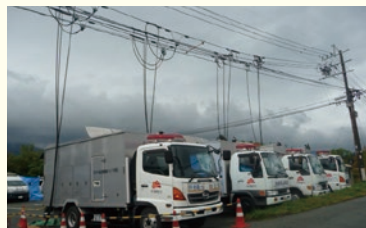
▲ 発電機車による復旧支援
