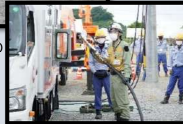
タンクローリーから発電機車への燃料補給（模擬）
