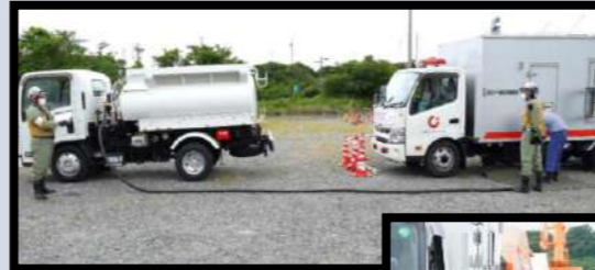
タンクローリーから発電機車への燃料補給（模擬）
