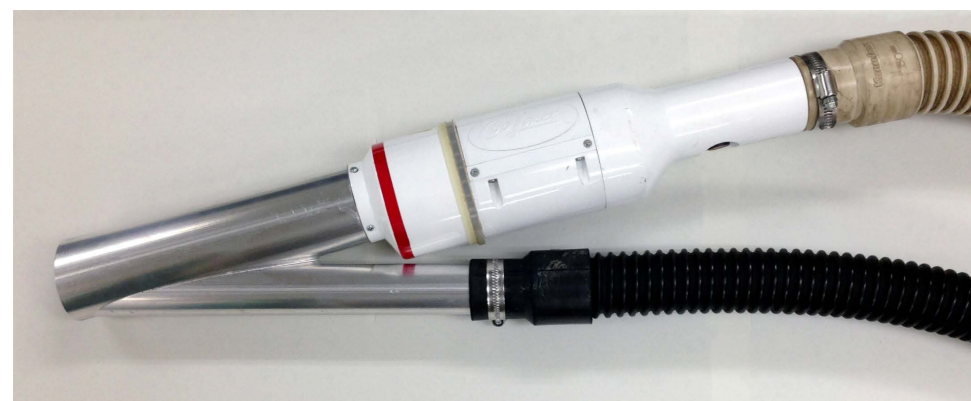
粉塵回収機構付レーザー照射ヘッド
