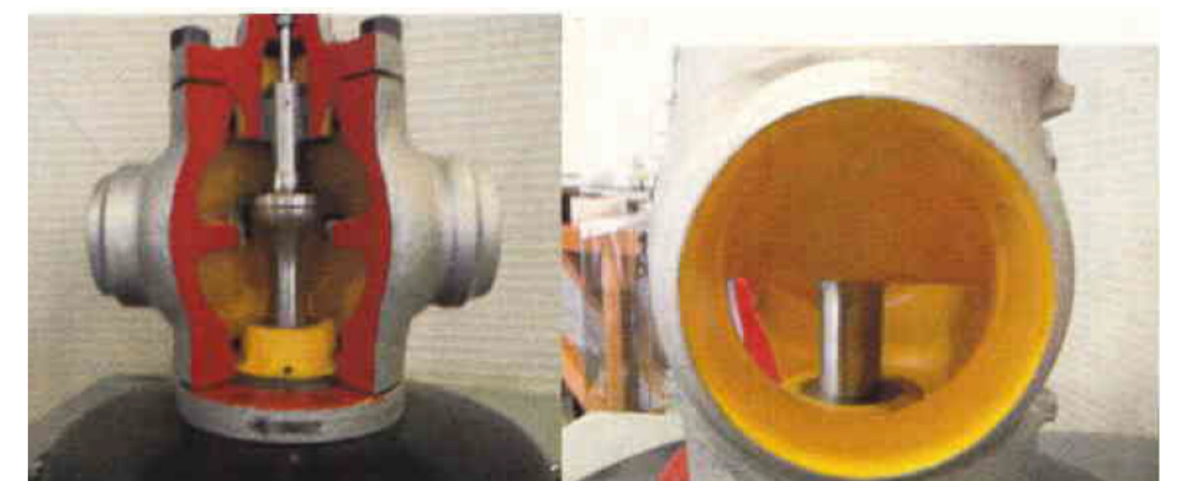
除染対象物の例（バルブの弁箱内部）
