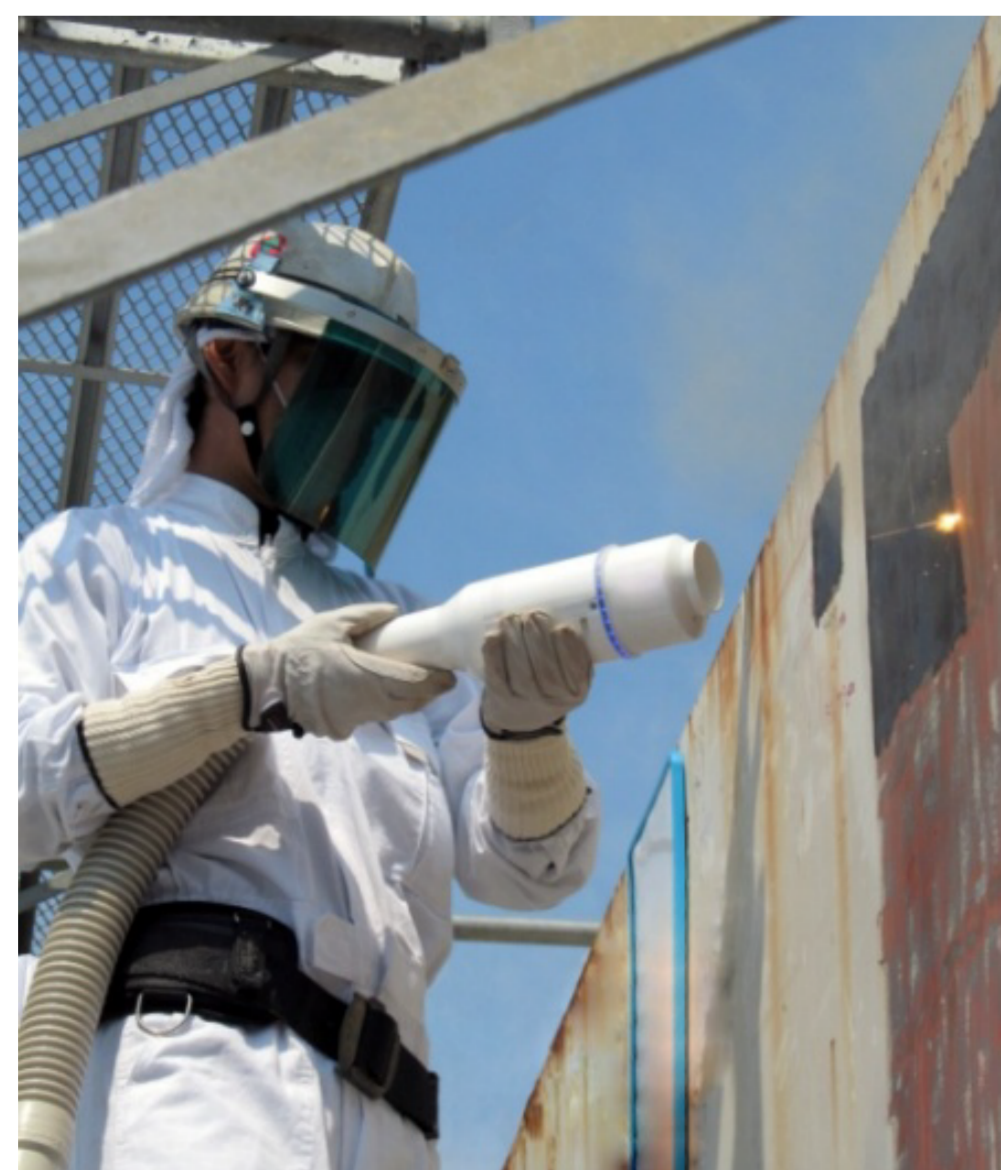
除染技術のベースとした「ポータブルレーザー塗膜除去装置」
