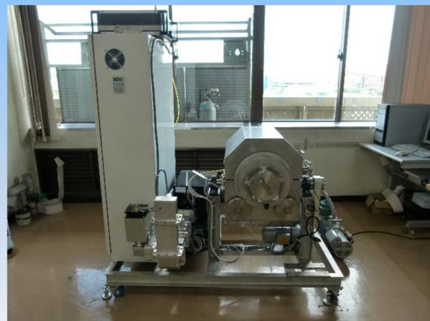
マイクロ波併用粉体加熱乾燥装置
