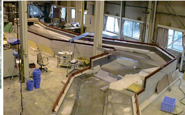
えん堤の堆砂対策 平成10年
