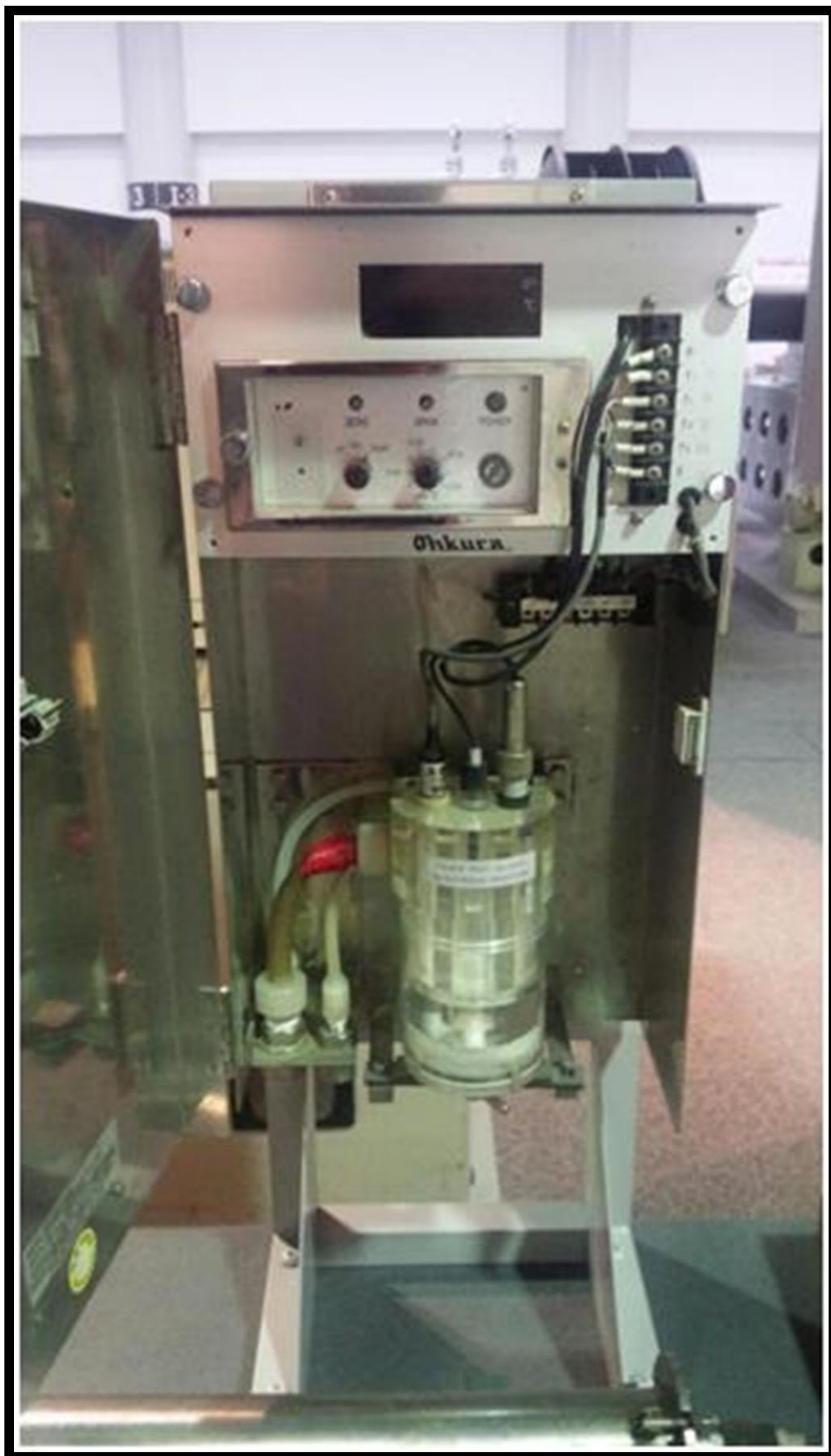
新名古屋火力 連続水質監視計器 (pH計)
