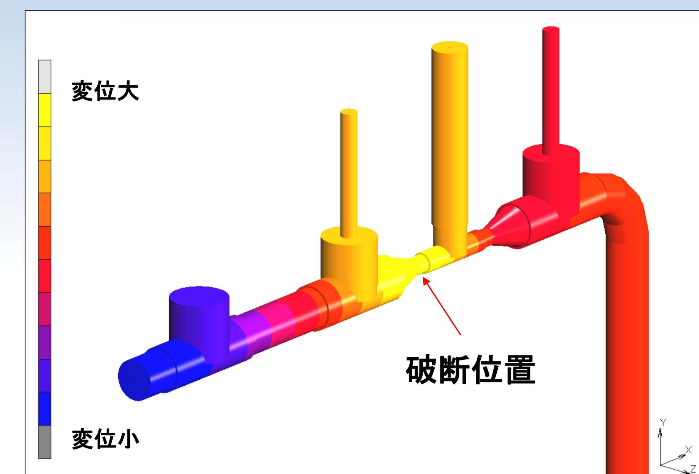
配管振動時の変位分布の例
