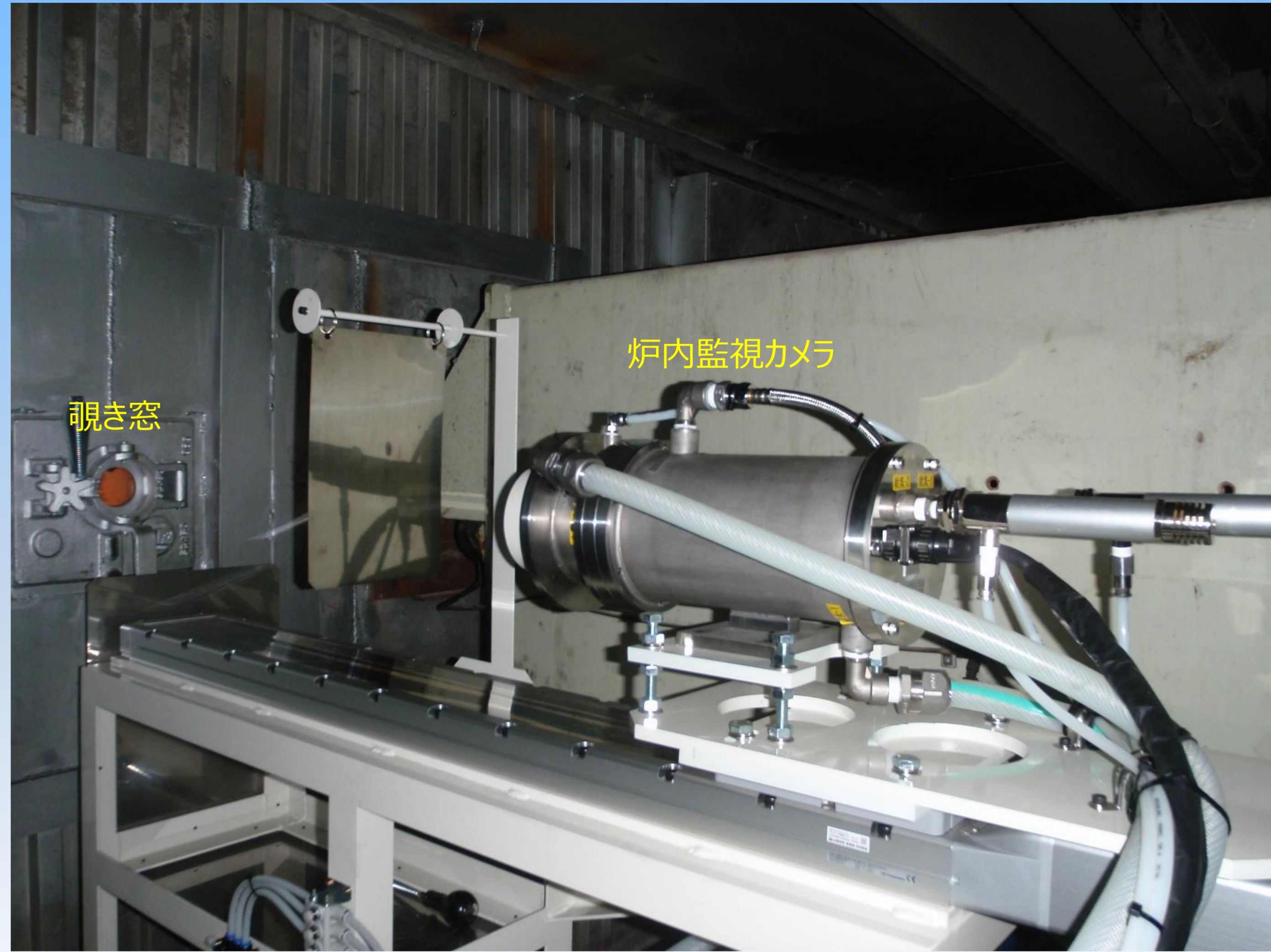
炉内監視カメラの外観
