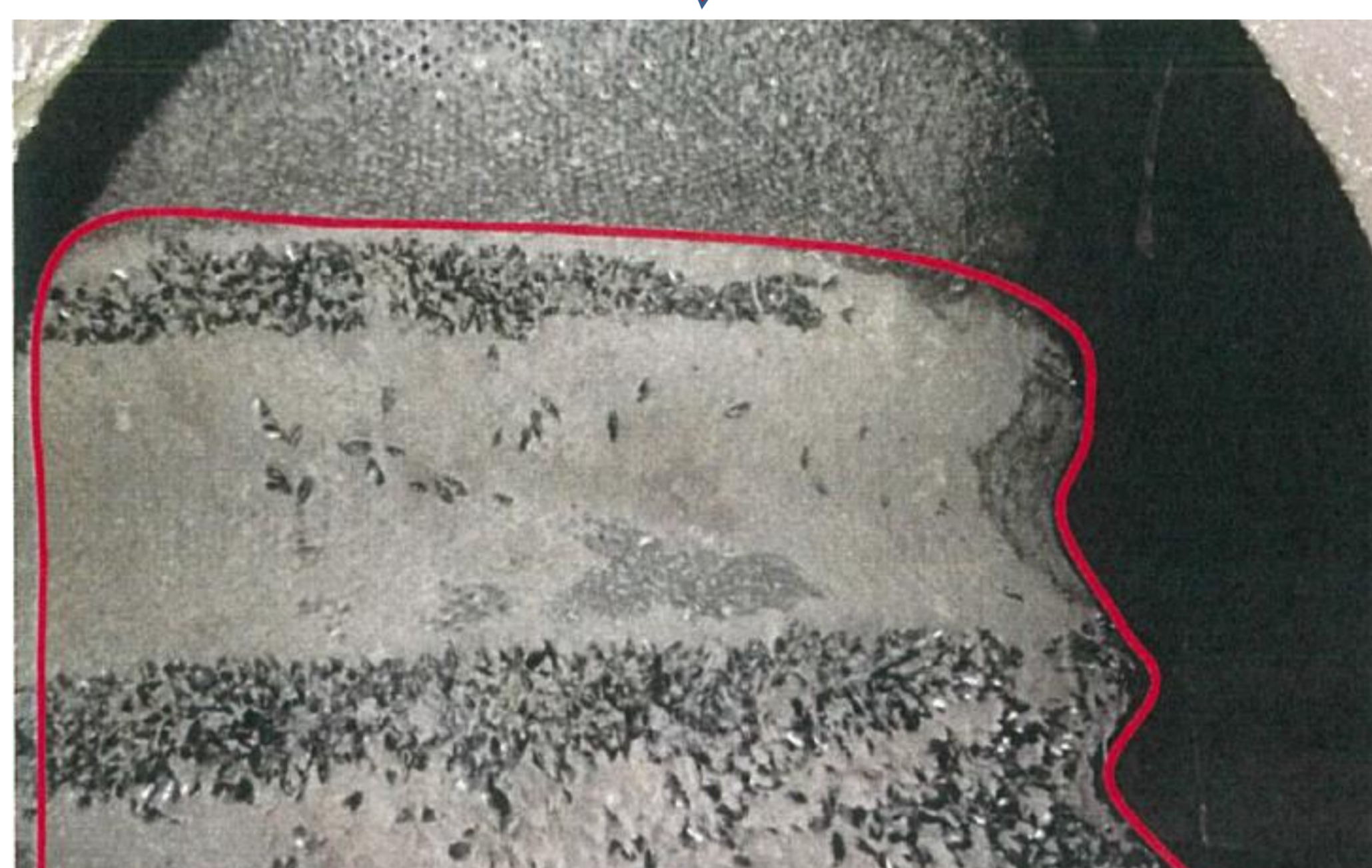
フィルタ外面に付着した石灰状付着物
