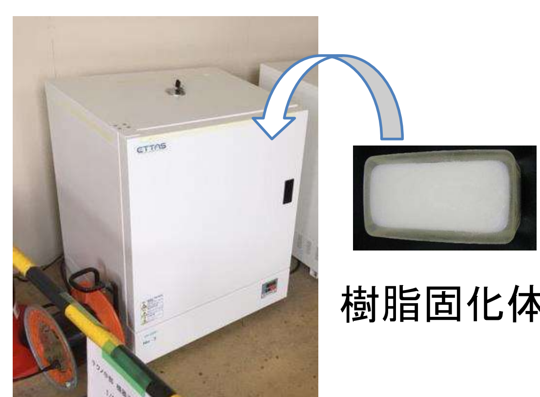
恒温槽による温度試験
