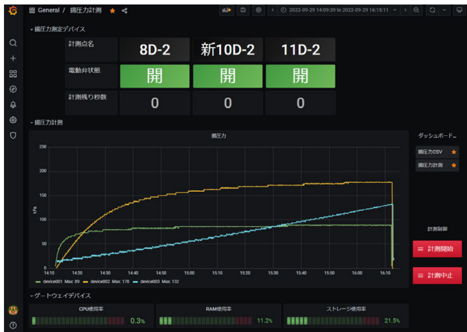
揚圧力計測ダッシュボード (クラウド)
