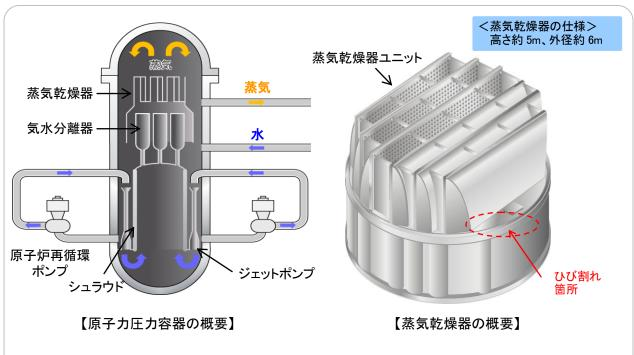
蒸気乾燥器は、タービン効率を上げるため原子炉圧力容器内で発生する蒸気に含まれている湿分を取り除く装置です。原子炉を「止める」「冷やす」「閉じこめる」機能に係る設備ではありません。
