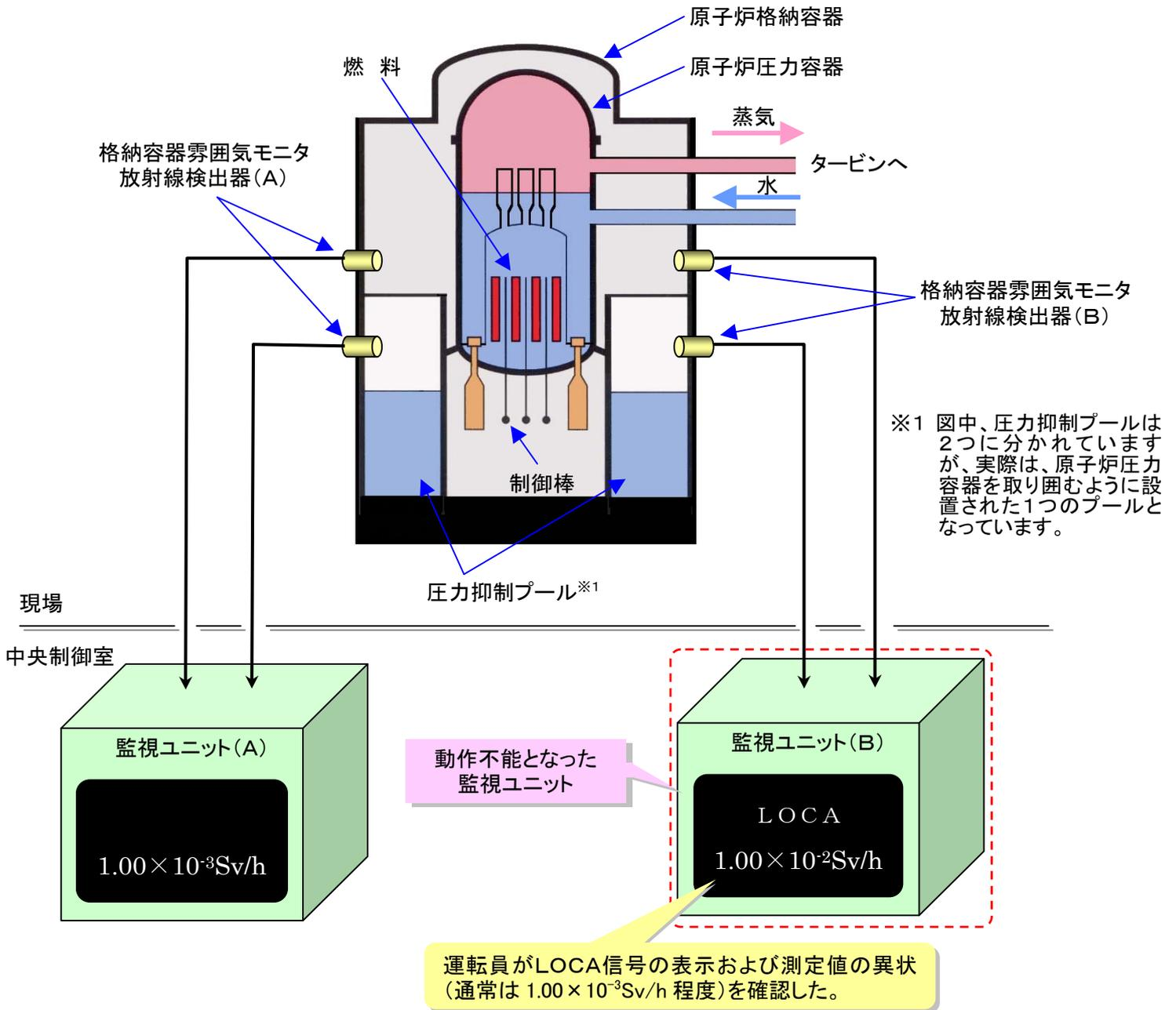
格納容器雰囲気モニタ(以下、「CAMS」という。)は2系統あり、原子炉冷却材喪失事故時に、格納容器内の放射線線量当量率等の測定を行う系統です。
