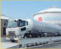
▲ LNG tanker truck
