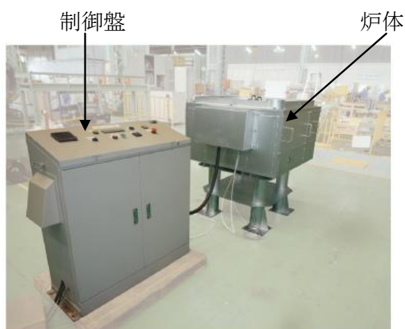
写真1 IH式アルミ溶解保持炉外観
