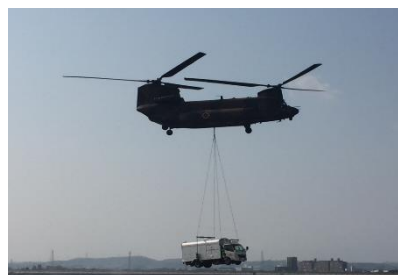
空輸型大型発電機車の空輸訓練
