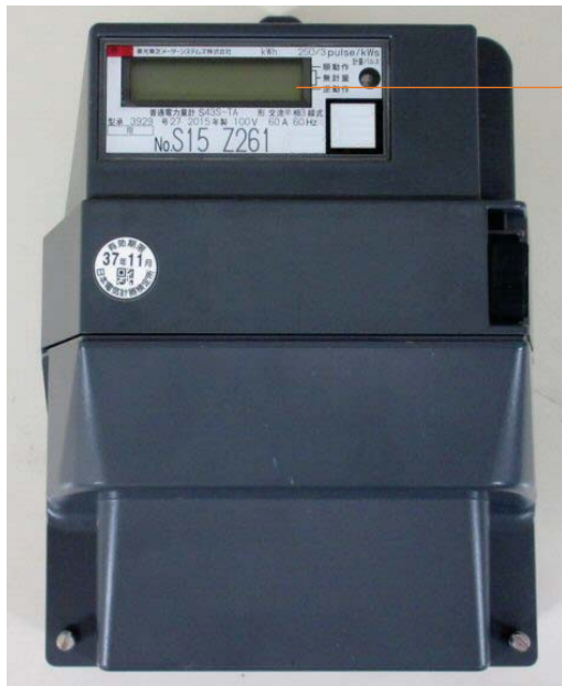
不具合が発生したスマートメーターの外観 (外観上の異常は見られない)
