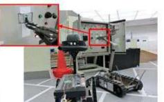
制御盤を開放しスイッチ操作
