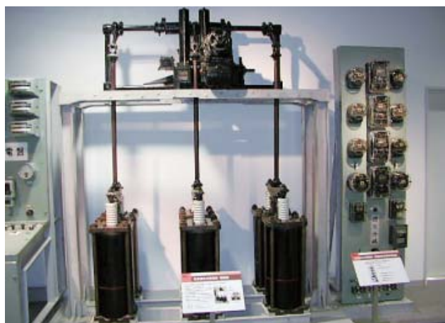
第8図 名古屋火力発電所遮断器
