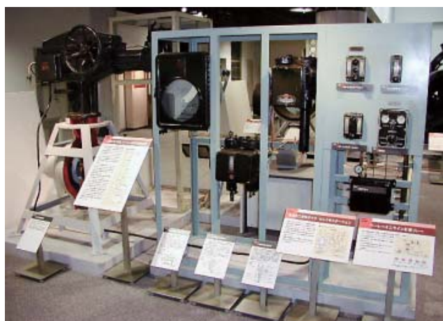
第6図 三重火力1号空気式ボイラ自動制御装置
