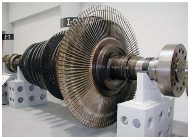
第9図 新名古屋火力高圧、中・低圧タービンロータ
