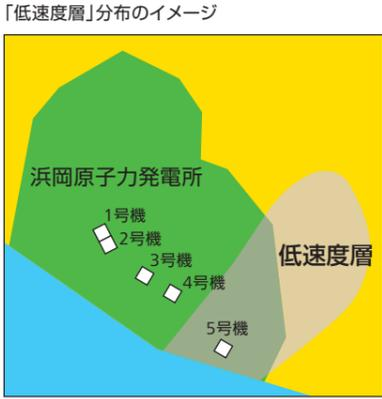
◆「低速度層」の分布を反映した解析を行ったところ、駿河湾の地震(本震)の方向からの揺れについて、5号機の揺れが3、4号機に比べて大きくなる結果が得られました。このことから、「低速度層」によって地震波が増幅したものと考えています。
