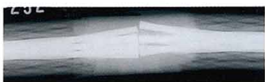
第6図 接続部の内部状況（X線撮影）
