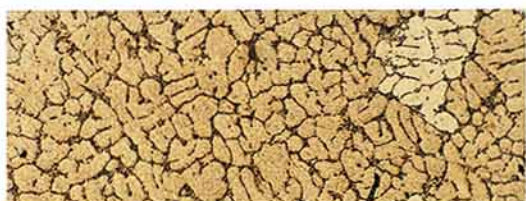
第5図 接続部の金属組織（倍率×41）
