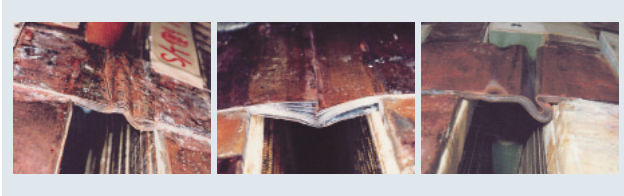
第4図 極間接続銅帯の変形例
