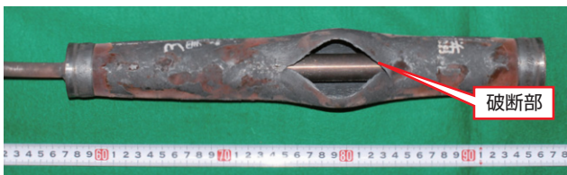
第3図 内圧クリープ試験片(試験後)
