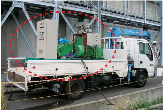
写真2 車載式生ゴミ急速処理プラント
