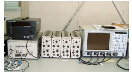
第6図 初期の超音波測定装置
