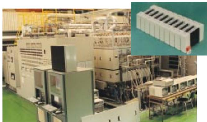
数10kW級固体酸化物形燃料電池発電試験装置と電池スタック
