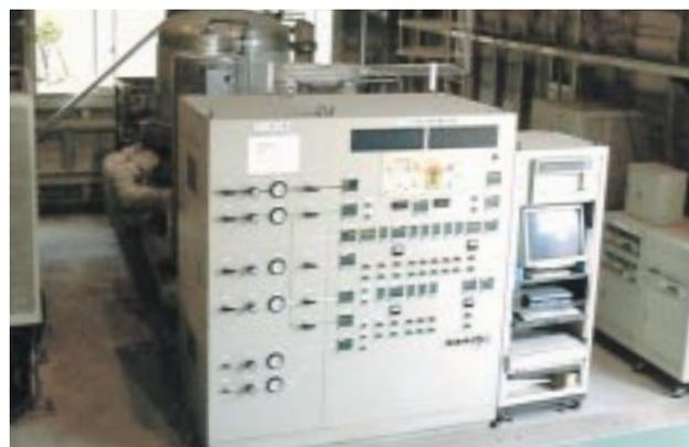
熔融炭酸塩形燃料電池発電試験装置
