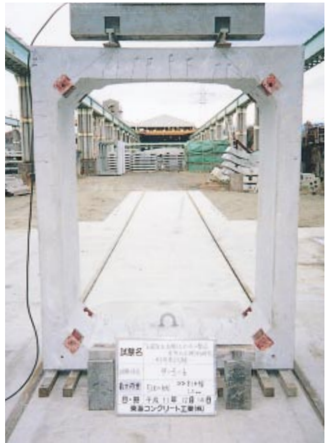
第2図 耐荷重試験(試験荷重載荷状態)
