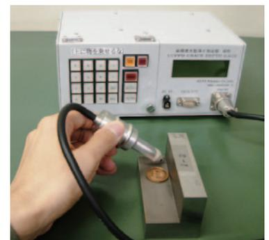
狭隙部用高感度き裂深さ測定器
