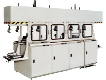
過熱水蒸気式高速乾燥器
