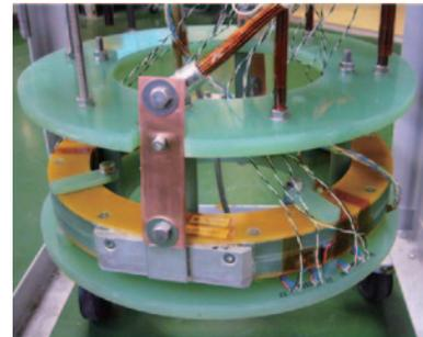
世界最高強度の次世代超電導コイル
