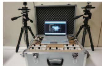
音カメラ「KYORImo」装置全景
