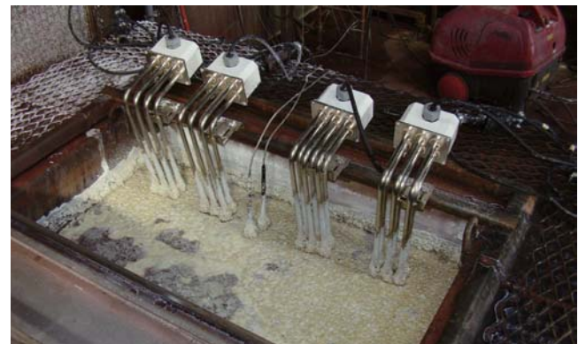
第4図 フィールド試験中の電気ヒーター
