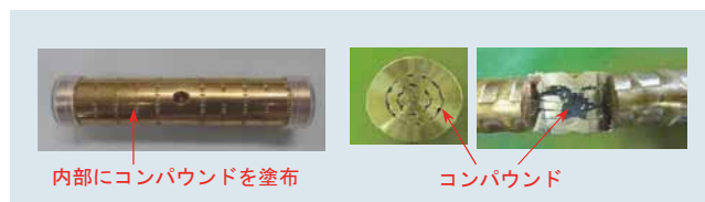
第2図 現行スリーブの外観図および断面図
