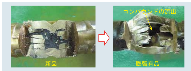
第4図 コンパウンド流出状況図
