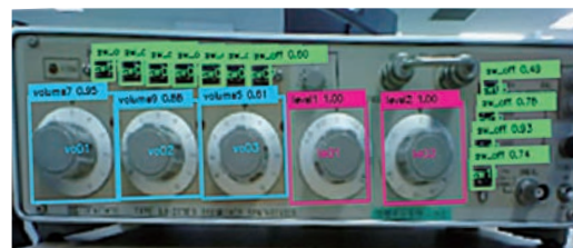
同一形状の物体を個別に識別した例 (ダイヤルやスイッチ等、同じ形状の物体を識別)
