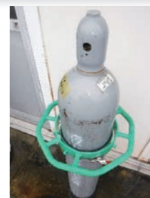
ポンベにアシスト器具を装着した状態
