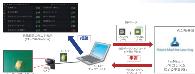
第5図 ローカル環境での判別モニタリング装置例
