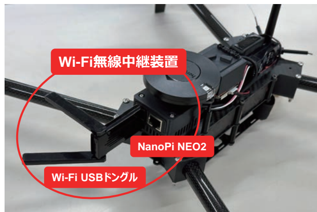
第3図 Wi-Fi無線中継装置外観写真
