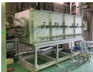
第2図 アンモニア燃焼試験炉
