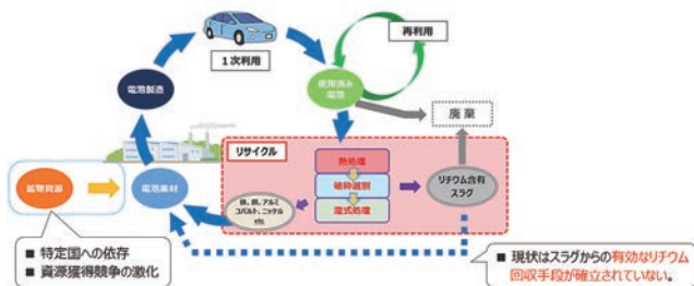
第2図 リチウムイオン電池の再資源化サイクル
