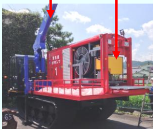
取水ポンプをクレーンで 水源に降ろし取水します。
