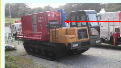
クローラ型取水ポンプ車 ※他のハイドロサブ等と同じ 海拔約38mのエリアに配備
