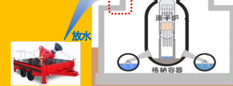
可搬型放水設備
