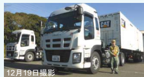
配備された交流電源車(4台配備)
