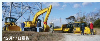
配備された重機(4台) 左から:ホイールローダ 油圧ショベル クローラキャリア ブルドーザ
