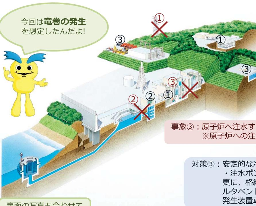
事象①：竜巻により送電系統が故障し、外部電源が喪失（3系統6回線）
