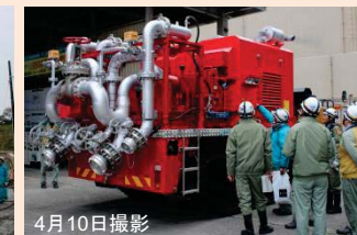
4月10日撮影 注水ポンプ車操作訓練の様子 (取水ポンプで吸い上げた水の圧力を上げて、原子炉に注水する設備)
