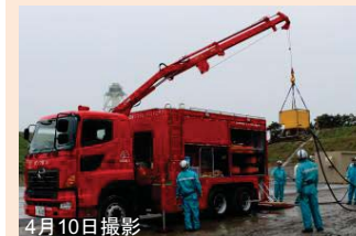
4月10日撮影 取水ポンプ車操作訓練の様子 (水源から水を吸い上げるための設備)
