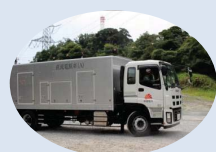
①直流電源車を所定の場所へ移動させる様子(社員が運転しています。)
