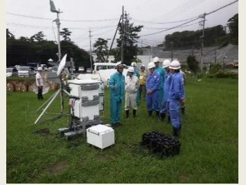
可搬型気象観測装置点検の様子
