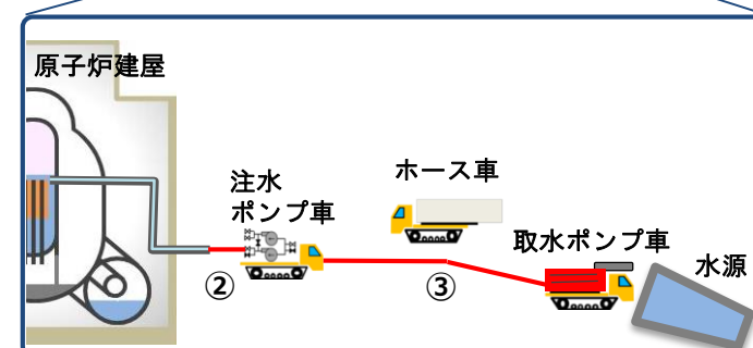
注水ポンプ車から原子炉建屋にホースを敷設している様子
