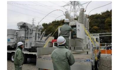
試加圧試験の様子（発電所構内の開閉所付近）
