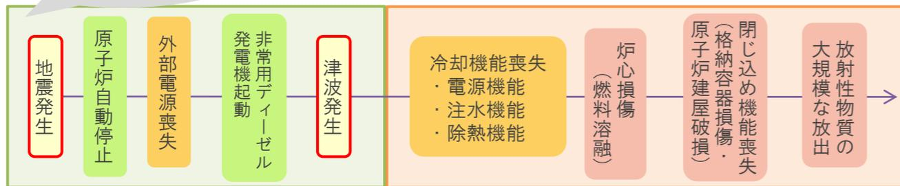
発電所では、福島事故の前から電源や注水、除熱の機能をもつ設備を多重性・多様性をもって配備していますが、事故以降、様々な追加対策を講じ、更に発電所の安全性を向上させています。
