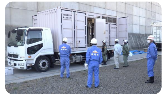
可搬型窒素ガス発生設備の現場確認状況
